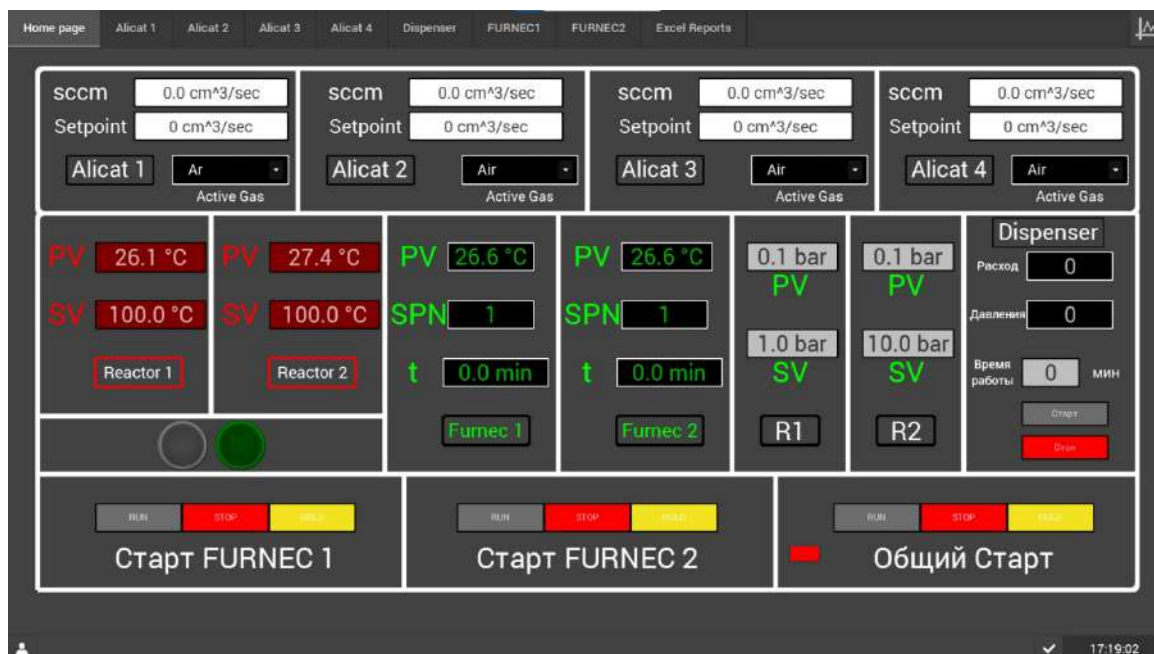
Рисунок 4.6 - Главная страница SCADA системы
